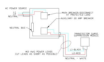
INSTALLATION DIAGRAM FOR 120/240V, SINGLE Ø VOLTAGE
